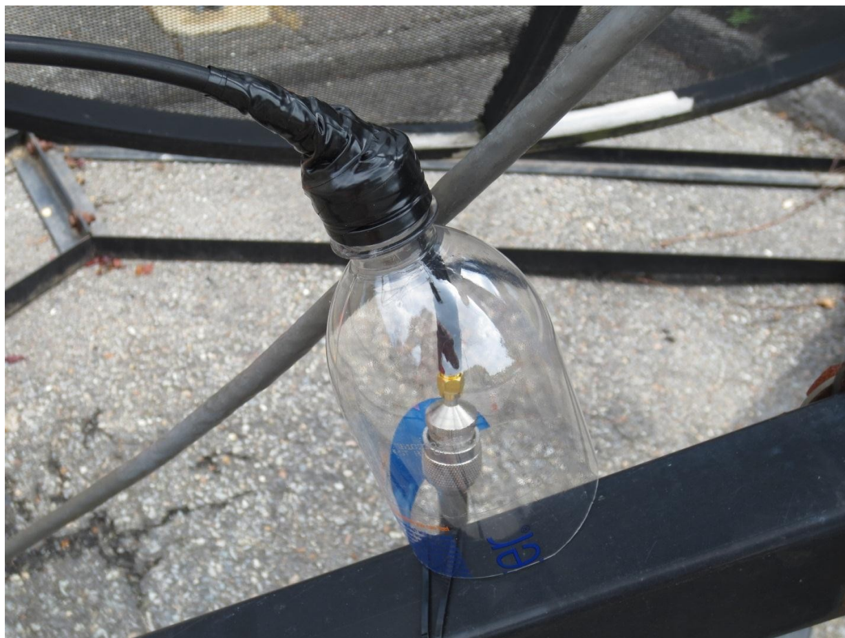
图 12: 两根同轴电缆之间的耐候连接。
