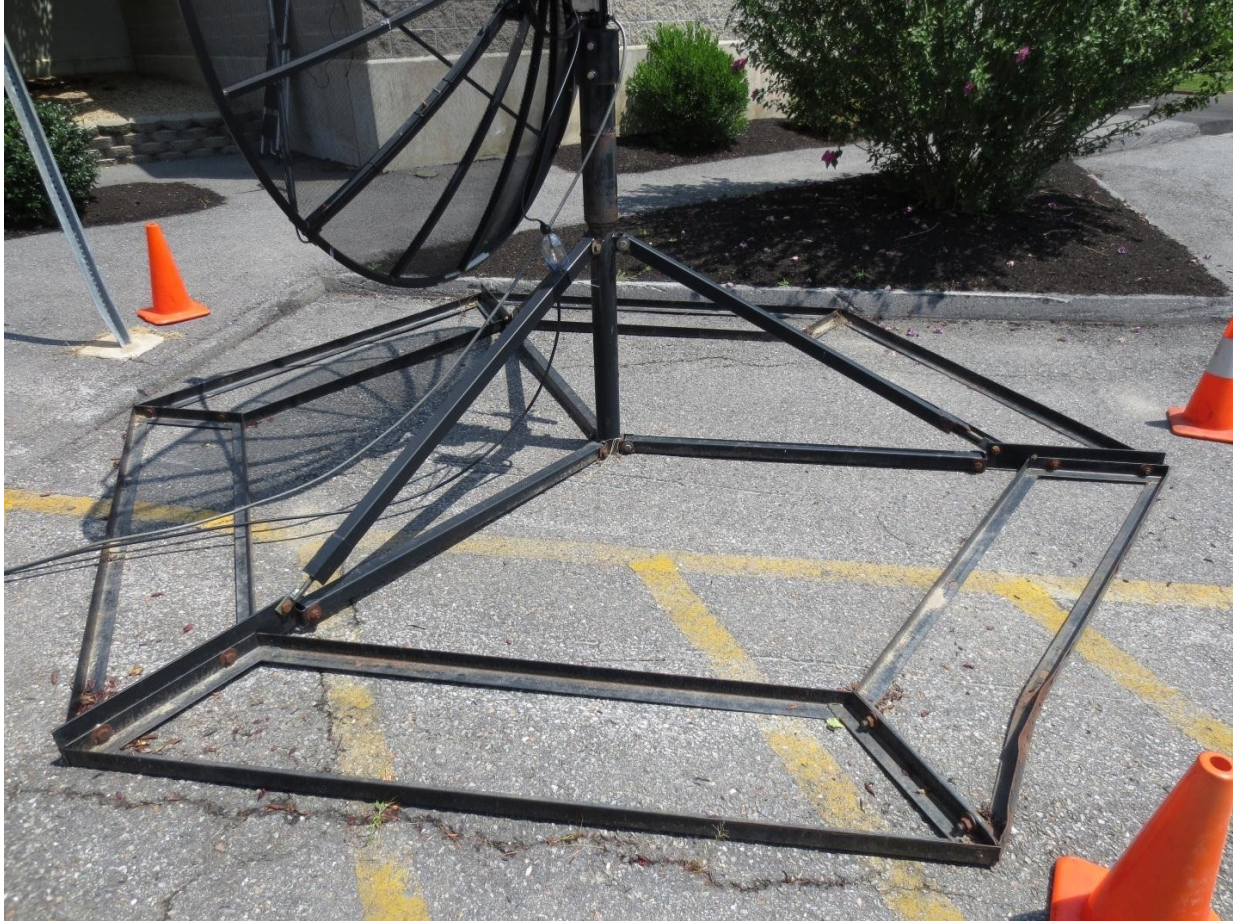
图 2:SRT 原型车的考尔电子 NPRM-10 安装架。混凝土块或其他配重应放置在周边的六个部分中。
