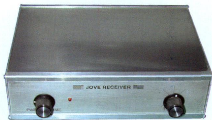
图3 木星RJ1.1直变接收机只有两个旋钮——开关音量和调谐。接收机的音频送到计算机声卡，也可以驱动有源音箱。接收机使用J310共栅极射频放大和传统的NE602混频本振电路和高增益音频放大器。可变电容可以在中心频率20.1MHz带宽400kHz范围内调谐。
