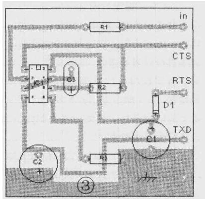
线及接口到计算机串口的引线均用屏蔽导线。焊接中注意9脚接口与25脚接口连线的区别,一些老计算机接口设备只有一个25脚接口,若你用的是9脚接头,这时可用一个9-to-25转接头来连接9脚与25脚接口。
