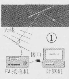
通过接口电路,信号传输到计算机里。接口电路完成音频信号到数字信号的转换,在软件的配合下,计算机可识别噪声和流星反射的电台信号,并自动完成记数、统计等工作。
