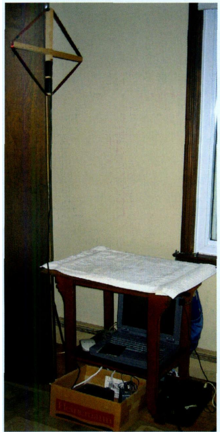
图7 接收系统整体示意图。左上是环形天线，架子上是电脑，底下的盒子里是收音机和模数转换器
