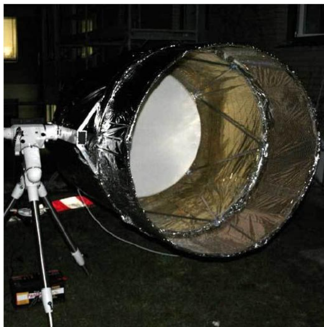
图 4. 用圆筒套住的抛物式天线
